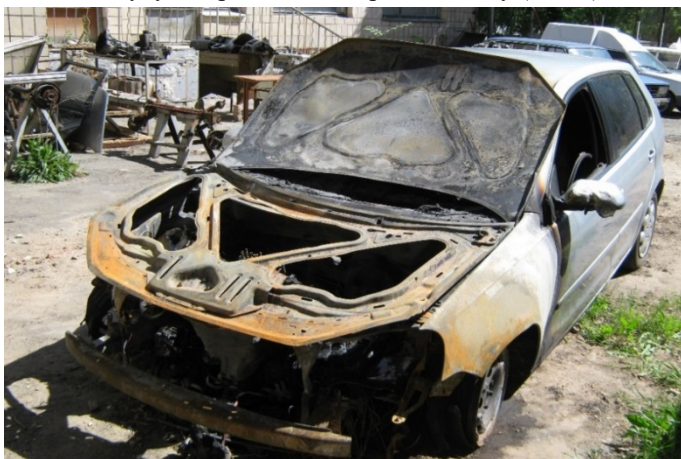
Рис. 2. Капот автомобіля після вибуху
