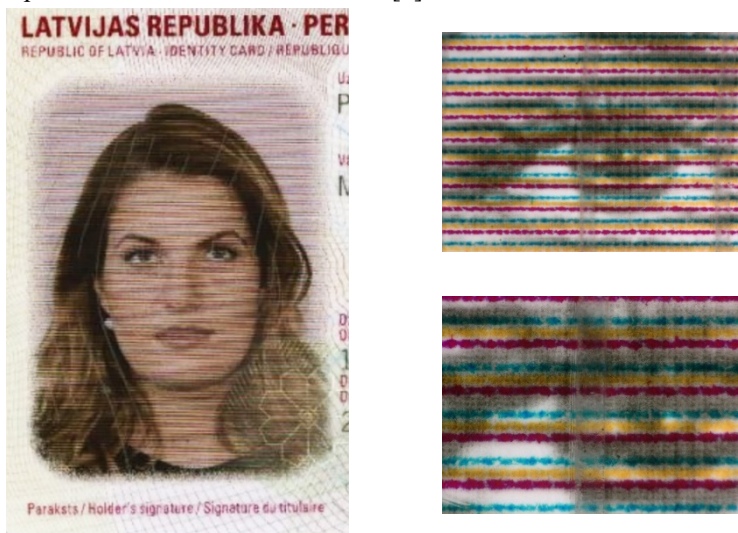
Рис. 1-3. Збільшені зображення елементів, нанесених з використанням технології LASINK
