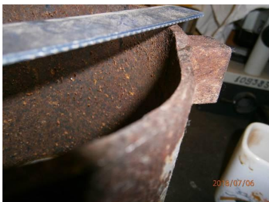
Рисунок 10. Фокус зламу та майданчика ковзання «лівої» опори
