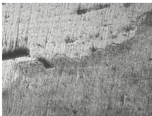
Рисунок 16. Мікроструктура зони зварного шва труби після виготовлення
