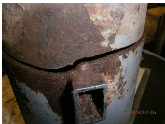
Рисунок 8. Місце зламу «лівої» опори
