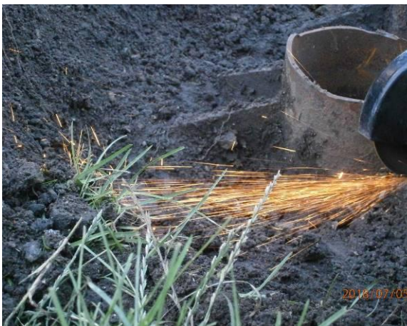
Рисунок 3. Відбір зразків на місці руйнування опор
