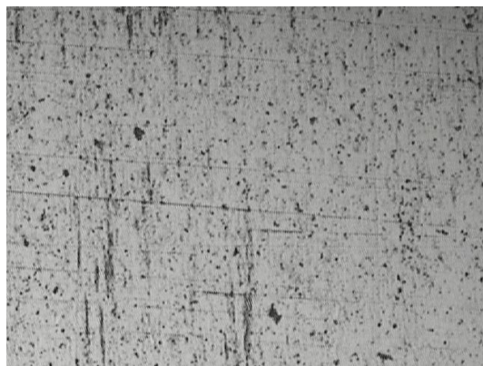
Рисунок 14. Мікроструктура поздовжнього мікрошліфа труби, без травлення, х 295
