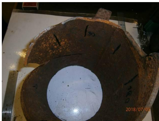
Рисунок 11. Злам «правої» опори – вигин із крученням
