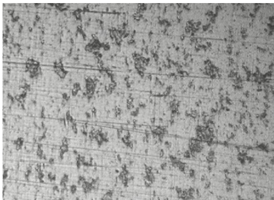
Рисунок 17. Поздовжній мікрошліф після травлення, х 295
