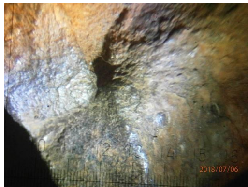
Рисунок 12. Фокус зламу «лівої» опори, x 4, zoom 3
