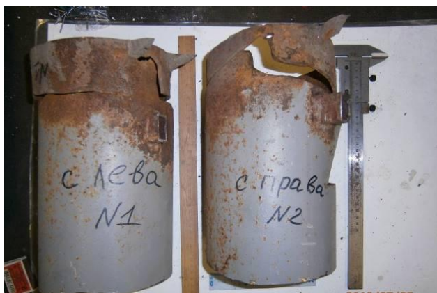
Рисунок 5 Темплети вивчення причин руйнування (позначення відповідають рис. 1)
